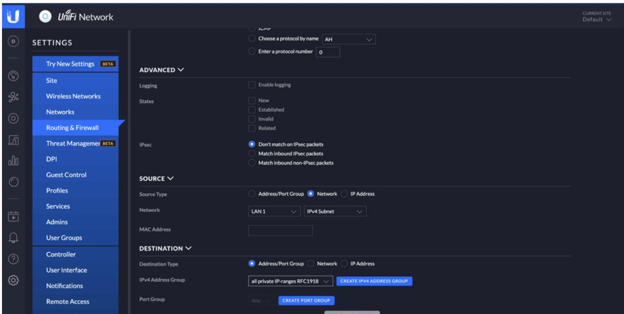
Die nachfolgende Regel unterbindet die Kommunikation zwischen den Subnetzen (VLAN'S).
