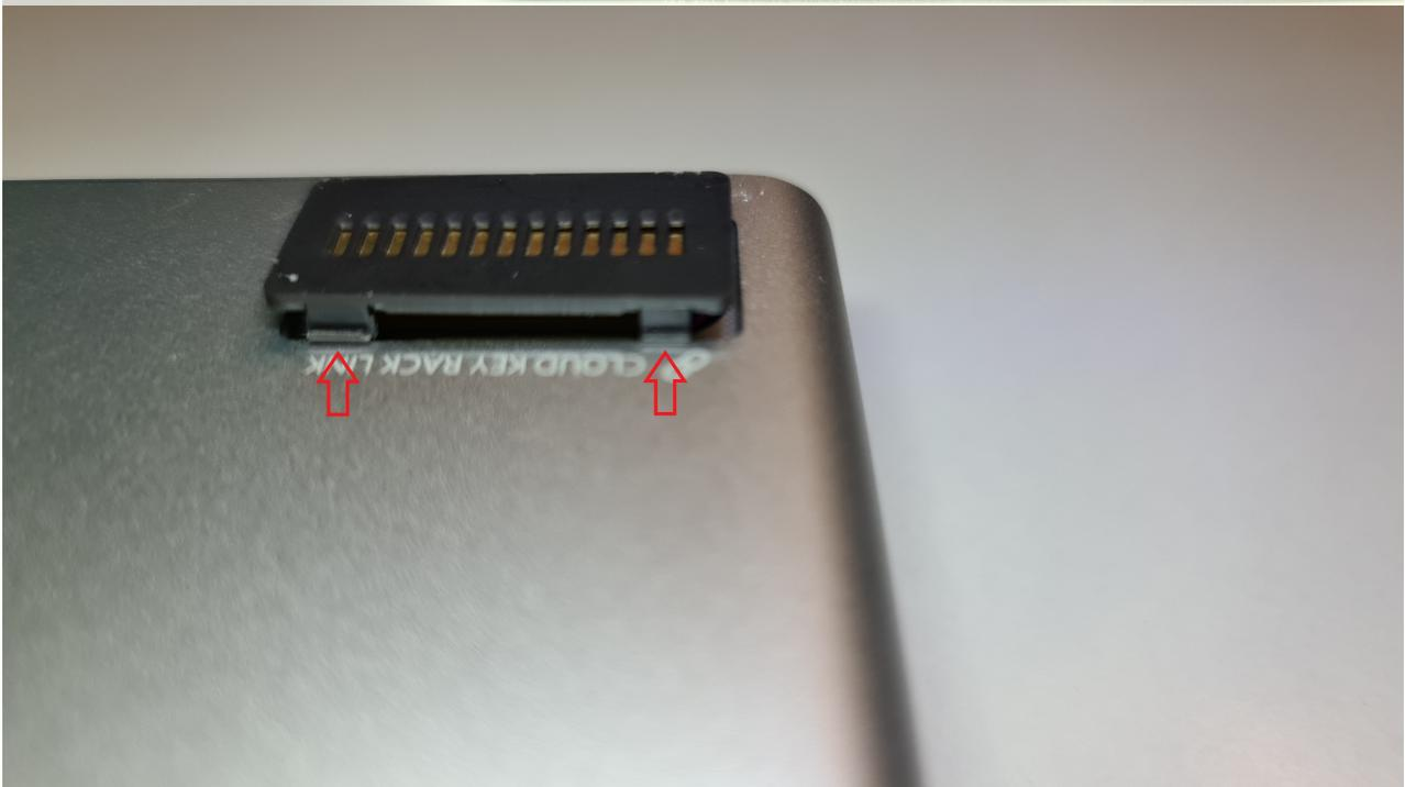
Jetzt können wir die Kontaktleiste vorsichtig herausziehen und dann den Stecker lösen, Kabel und Stecker bitte wieder im Gehäuse verstauen, da er beim Ausbau sich sonst darin einquetscht.
